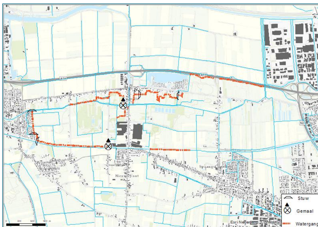
Afbeelding 4.3 Globale maatregelen waterhuishouding ten behoeve van mitigeren wateroverlast (voor meer details zie bijlage I, waarbij verschillen bijlage I leidend is)
