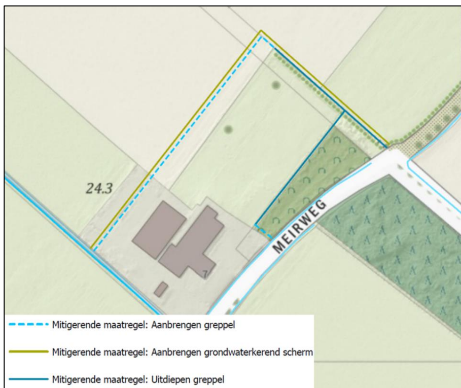
Figuur 47: Overzicht aanbrengen grondwaterkerend scherm incl. greppels
