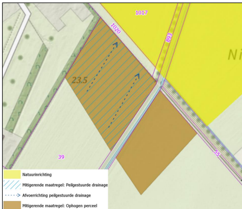
Figuur 45: Overzicht en afwateringsrichting peilgestuurde drainage BDL01-L-39
